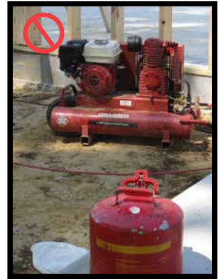
Keep gas cans at least 10 ft. away from gas powered equipment Mantener la lata de gasolina por lo menos a 10 pies de distancia de equipos que usan gasolina
