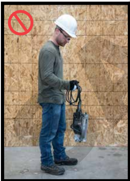
Do not carry tools by their cord. No cargar las herramientas por los cables.
