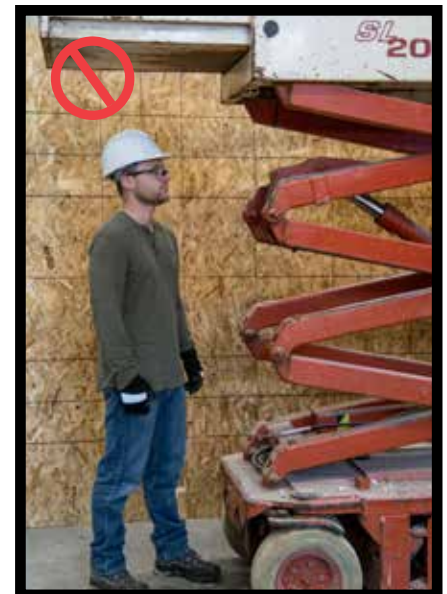
Do not go under the aerial lift. No pasar debajo del elevador aéreo.
